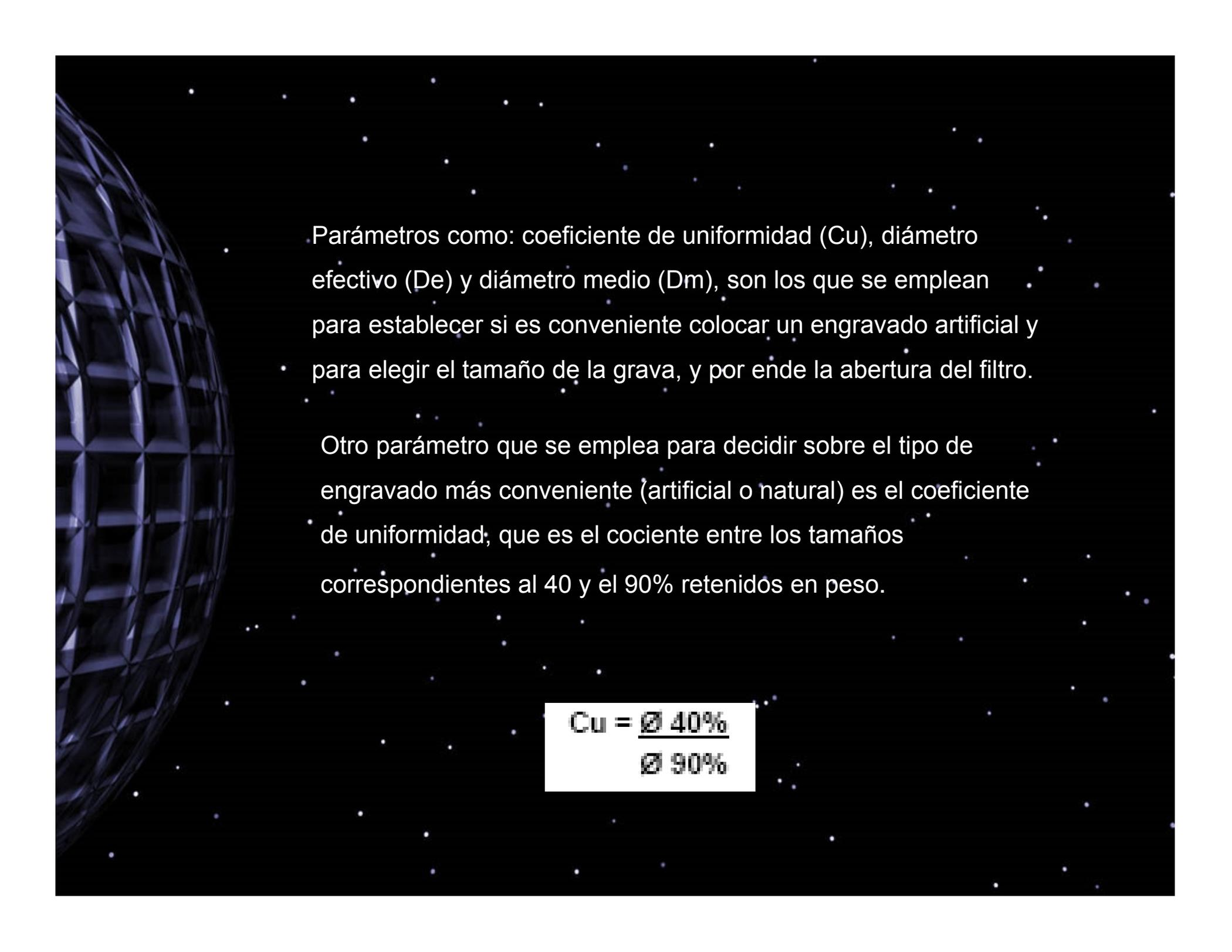
Parámetros como: coeficiente de uniformidad (Cu), diámetro efectivo (De) y diámetro medio (Dm), son los que se emplean para establecer si es conveniente colocar un engravado artificial y para elegir el tamaño de la grava, y por ende la abertura del filtro.
