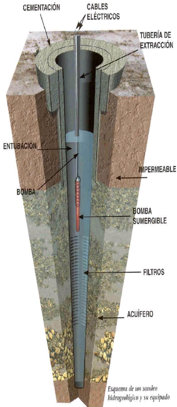
*Esquema de un sondeo hidrogeológico y su equipado*
