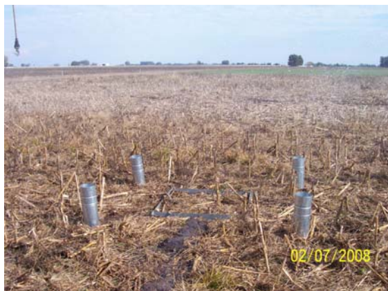
Figura 1a: Instalación de bandejas y pluviómetros clase B.
